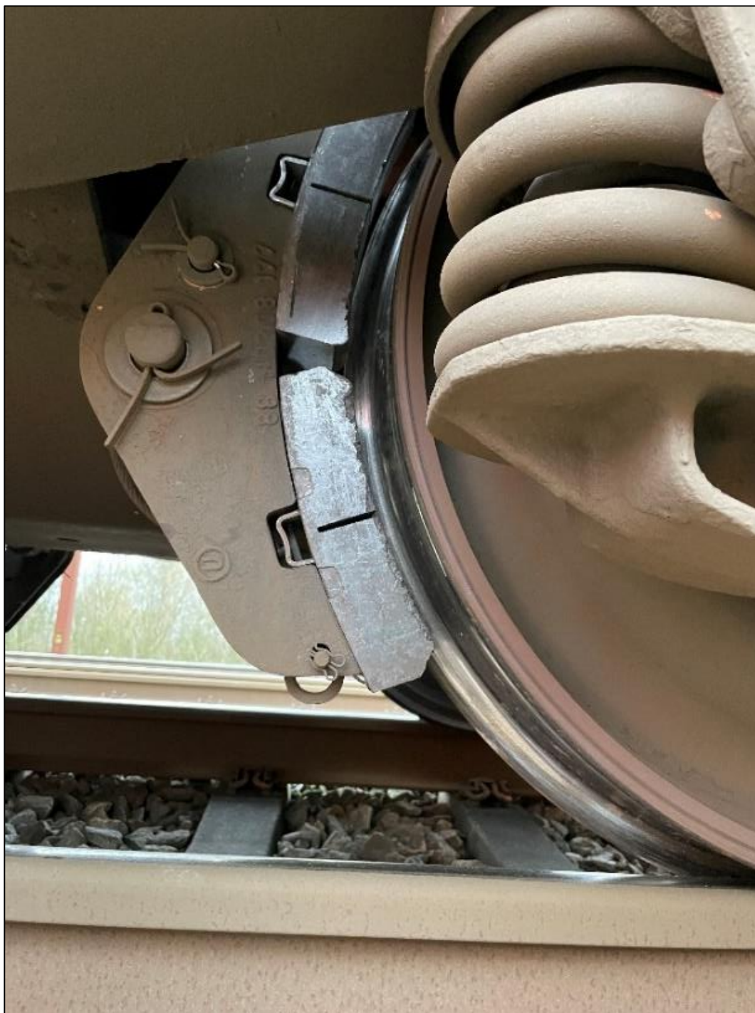
Foto 3. Nye bremseklodser. Vognens 3. aksel, højre side.
