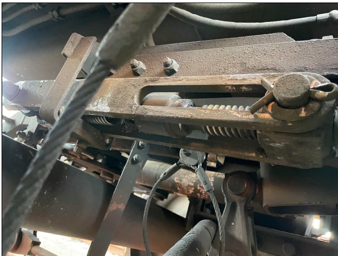
Foto 2. Skruebremseaktuator med gevindstang 8-9 omgange fra endestilling.
