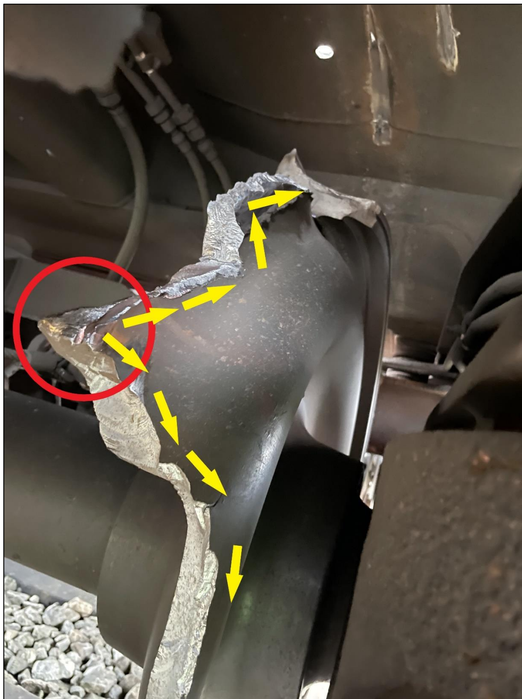
Figur 2. Initieringssted (startsted) og udbredelsesretning. Kilde: Force Technology.
