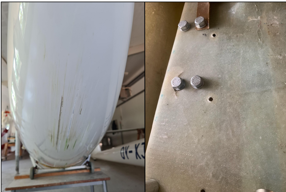
Figur 1. Til venstre ses skader på bunden af svæveflyet. Til højre ses revner på hjulkassen.
