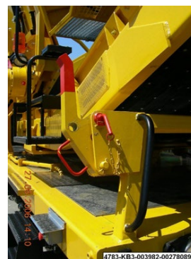
Sikringslås i position 2.
