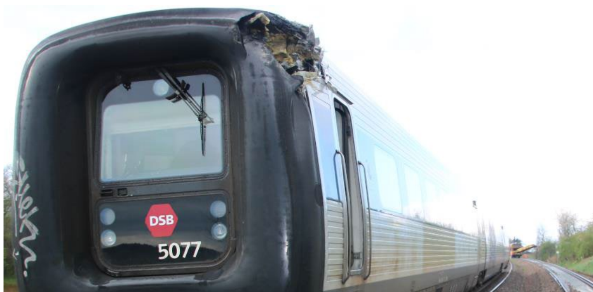
Uheldsstedet set i køreretning Skørping - Hobro. Togets front holdt i km 203,920. Udlægger-båndet / kollisionssted ses i baggrunden – afstand ca. 200 meter, rundt om vognen. Anslag af udlæggerbåndet. (Foto DSB).
