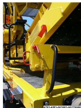
Sikringslås i position 1.
