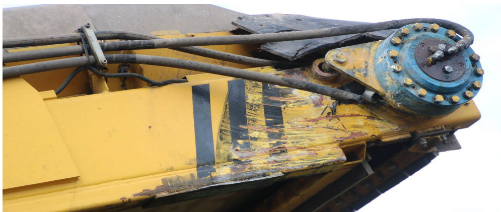
Mærker på udlæggerbåndet efter kollisionen med toget. (Foto DSB).
