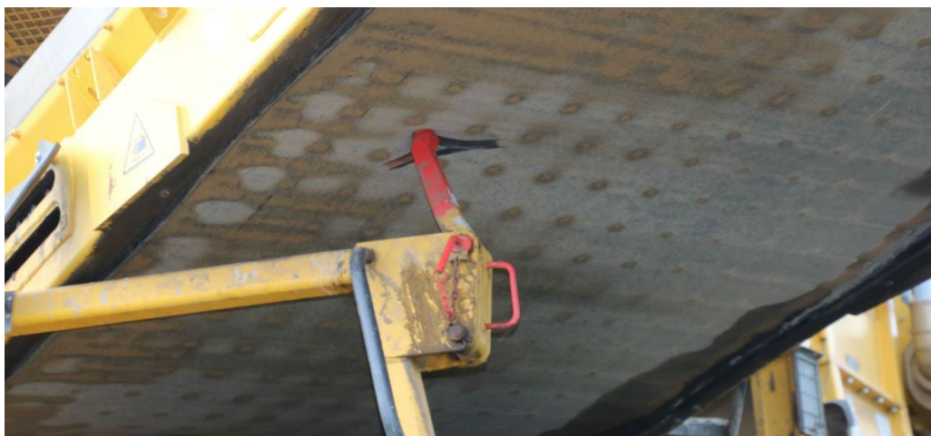
Sikringslås i ballastsilovognens højre side var (mod grøft) i position 1. Billede viser at udlæggerbåndet i forbindelse med kollisionen var blevet skubbet op over sikringslåsen. (Foto DSB).
