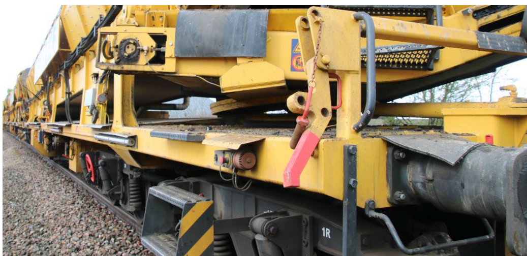
Sikringslås i ballastsilovognens venstre side (mod nabospor) var i position 3. (Foto DSB).
