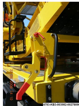
Sikringslås i position 3.
