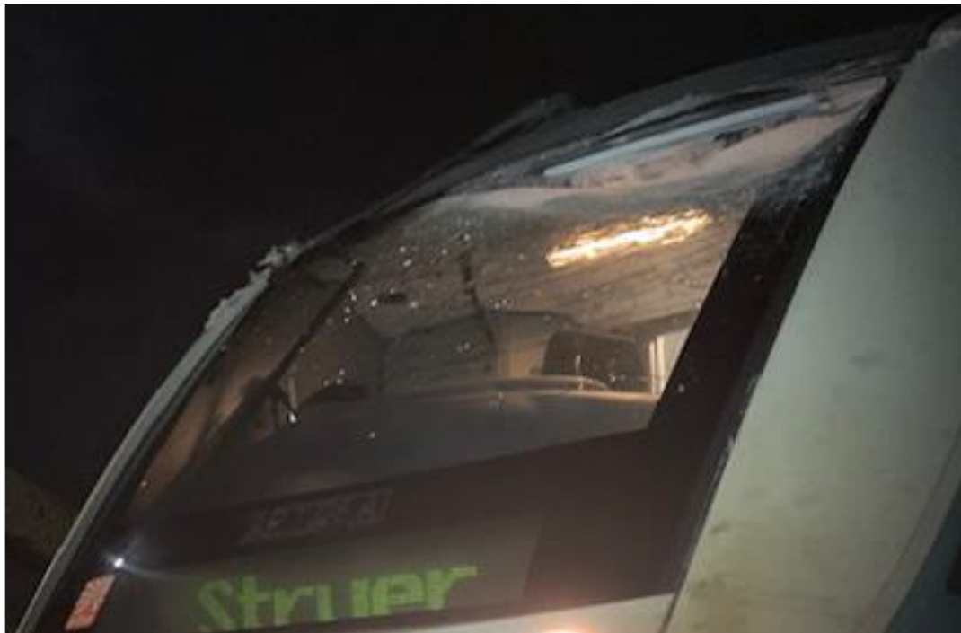
Foto 2 Skader på fronten af togsættet - det ses hvor bunden af kurven har ramt.
